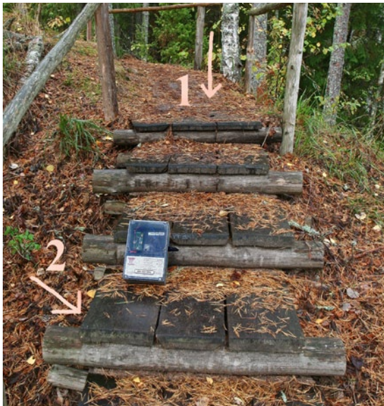
Painemattolaskuri on hyvä asentaa portaisiin. Numero 1 osoittaa painematon paikan ja numero 2 laskurin yleisimmän kätköpaikan (portaan alla). RMK:n Pohjois-Viron virkistysalue, Viro. Kuva: Jaak Neljandik.
