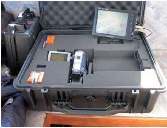
Kuva 11. Veneen tallentava videolaite, joka koostuu iskunkestävästä salkusta, lisäakusta, videokamerasta sekä näytöstä, josta vedenalaisia tapahtumia voi seurata sukelluksen aikana. Kuva: Metsähallitus 2007.
