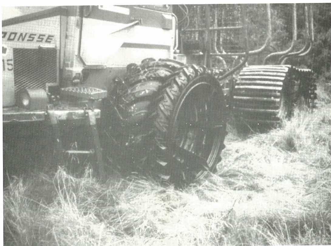
Kuva 7. Kehittämisjaoston ja paikallisen konepajan suunnittelema levikepyörävarustus /17/. Renkaan leveys 240 mm.
