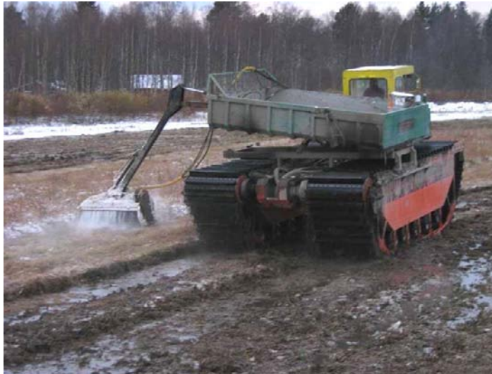
Kuva 28. Rantaniityn kunnostusta kaivinkoneella ja murskaimella. Tiina Niikkonen 2003.
