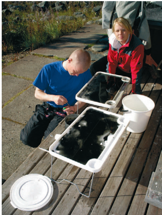
Kuva 11. Kenttäolosuhteissa tehtävään tarkkuusseulontaan sopiva tarjotinmalli. Kuva: Essi Keskinen 2007.
