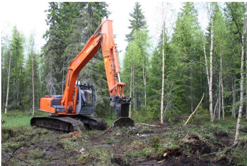
Kuva 4.1.1.2. Kaivinkoneella voidaan tehdä kasvupaikkakohtaista muokkauksen jälkeä. Ohutkunntaiset kohteet on mahdollista laikuttaa. Kuva Lauri Karvonen.
