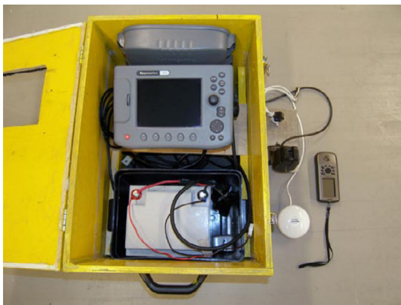
Figur 29. Den mobila plotterenheter med eget batteri. Utanför boxen syns ekolod, GPS-antenn och en separat GPS. Foto: Forststyrelsen 2006.
