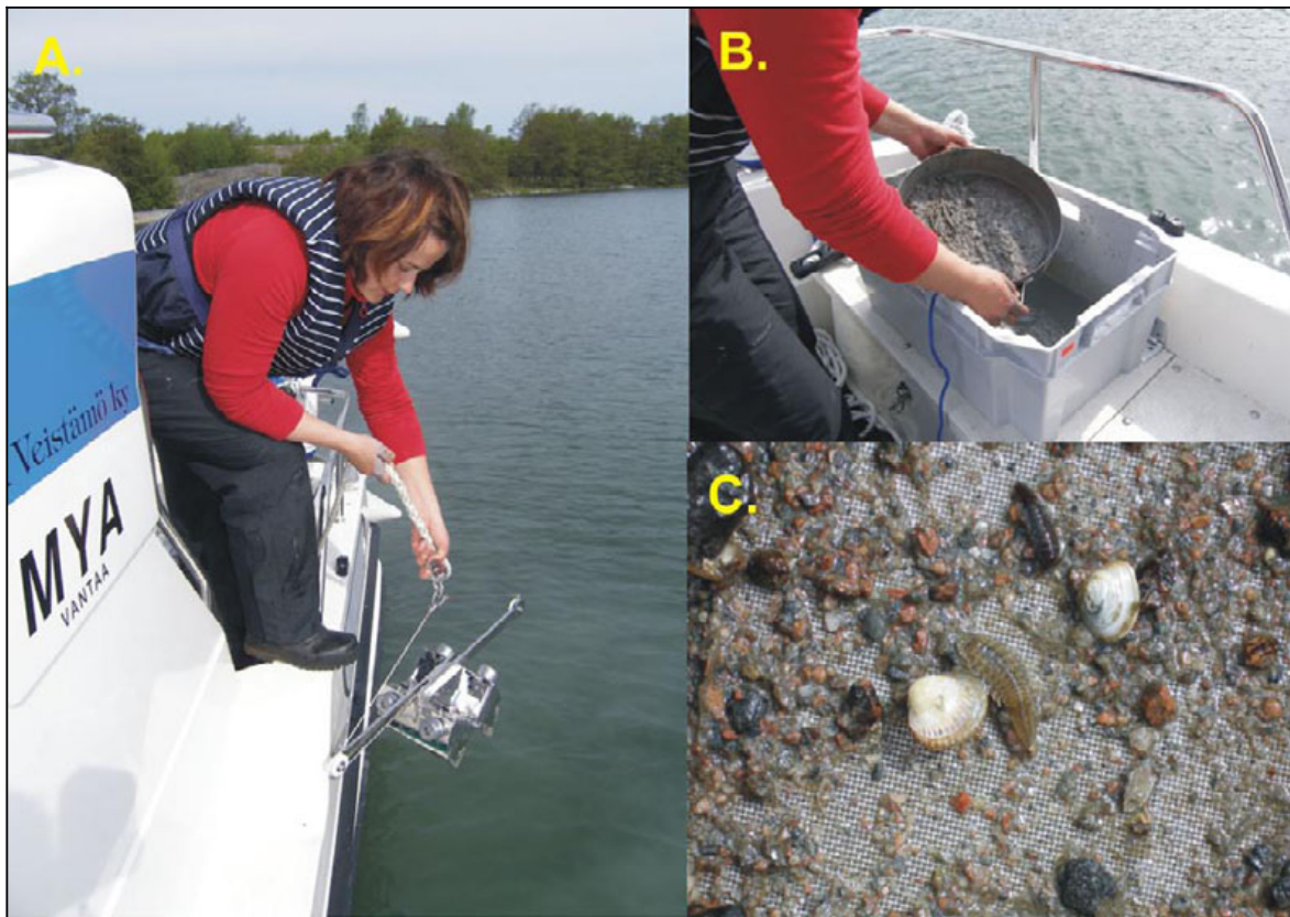
Figur 16. Proverna tas med en VanVeen bottenhuggare (A) och sällas (B). Fraktionen som blir kvar i sället (C) konserveras och analyseras. Foto: Forststyrelsen 2005.
