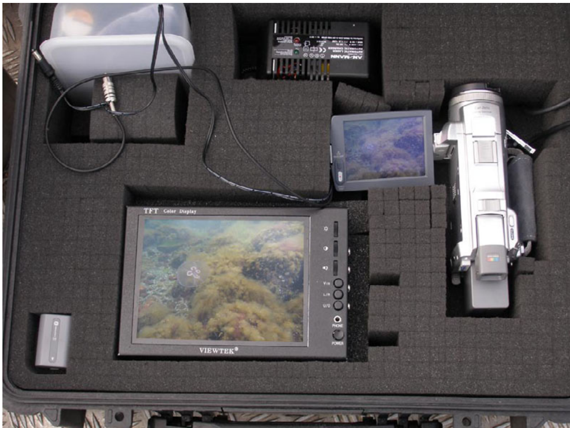
Figur 10. Videoboxen med videokamera, extern monitor, batteriladdare och extrabatteri. Foto: Forststyrelsen 2006.
