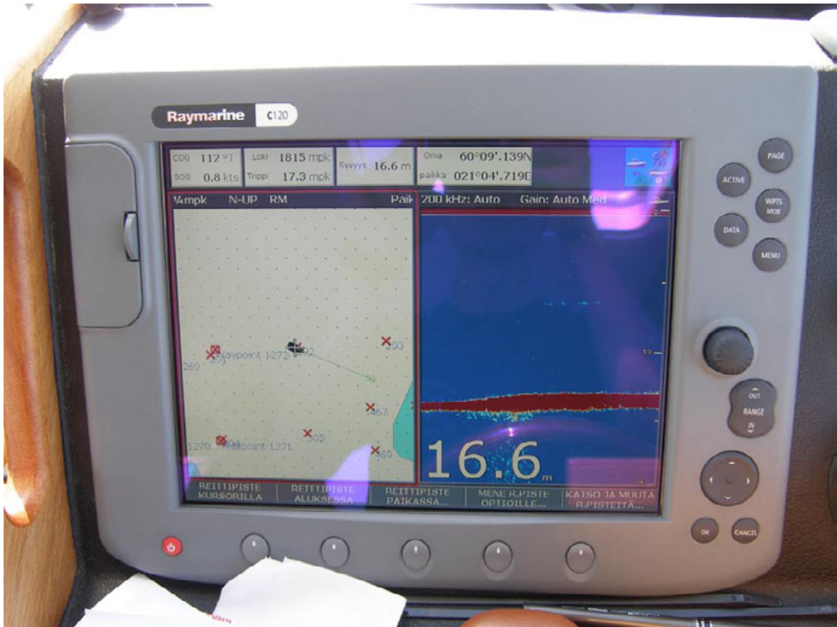
Figur 7. Båtens position framkommer ur det elektroniska sjökortet samtidigt som ekolodet gör en grafisk framställning av botten och djupet. Foto: Forststyrelsen 2005.
