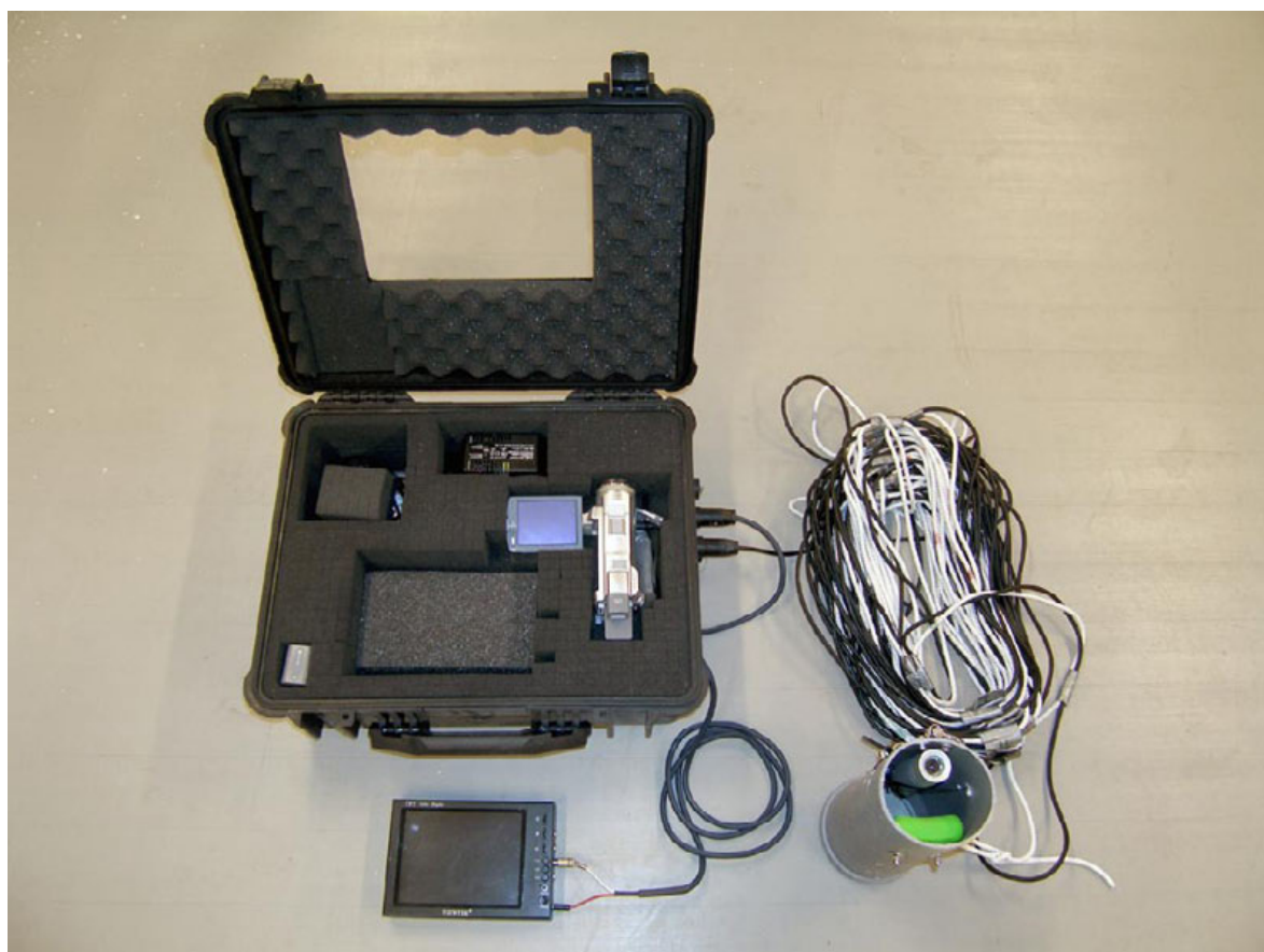
Figur 25. I videoboxen finns videokameran som är kopplad till undervattenskameran och till en extern monitor. Foto: Forststyrelsen 2006.
