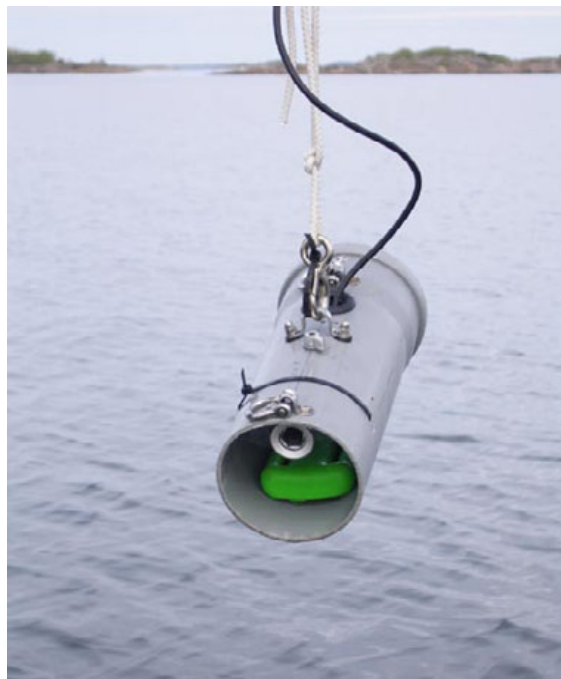
Figur 26. Undervattenskameran bestående av ett videohuvud, plaströr och en tyngd. Foto: Forststyrelsen 2005.
