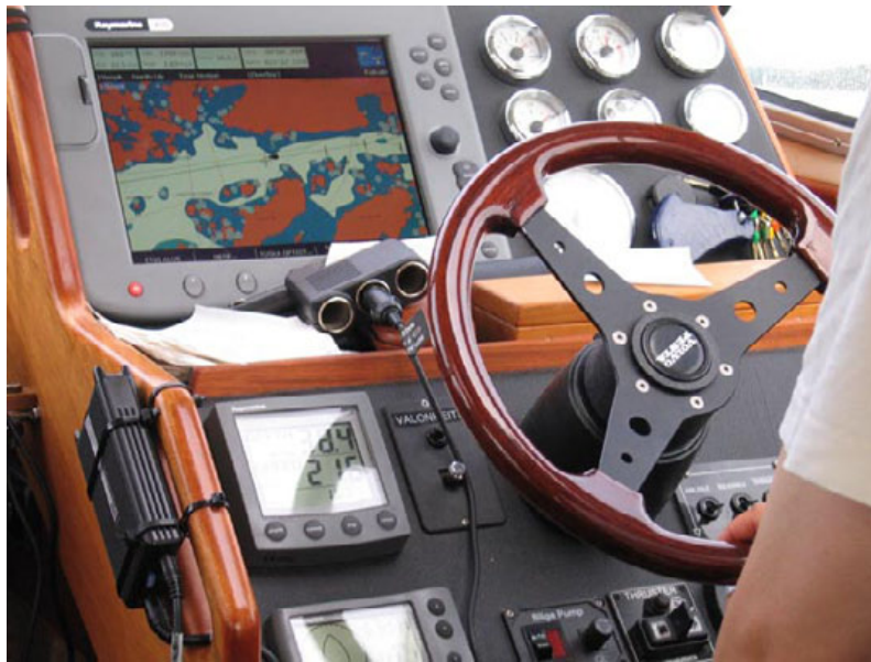
Figur 28. En fastinstallerad plotter i Tiiskeri. Foto: Forststyrelsen 2005.
