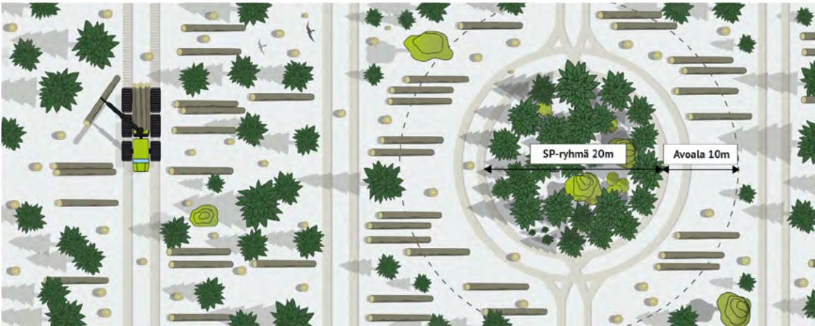
Kuva 66. Kaaviokuva säästöpuuryhmistä ja ajourista riistanhoidollisessa harvennushakkuussa. Ajouraväli on noin 20 m ja ajouraleveys 4,5 m. ILMARI HAKALA/SOPIVA DESIGN
