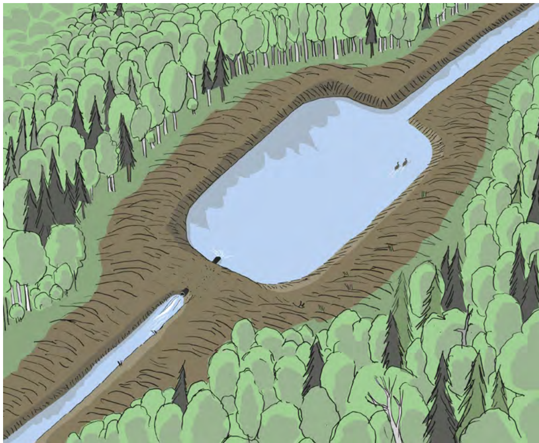
Kuva 81. Suositeltava laskeutusaltan muoto ylhäältä päin. ILMARI HAKALA/SOPIVA DESIGN
