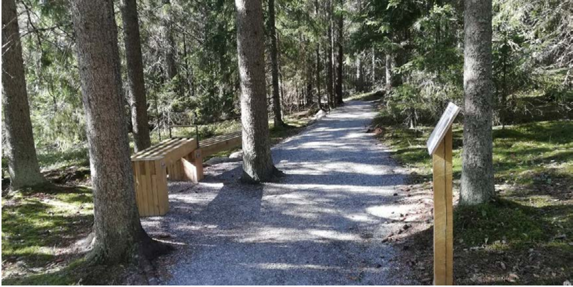
Kuva 6. Reitin taukopaikalla leveys mahdollistaa ohittamisen. Penkissä on kaksi korkeutta ja tilaa on myös apuvälineelle. Esimerkki Kurjenrahkan kansallispuistosta. Kuva: Jari Virnes.
