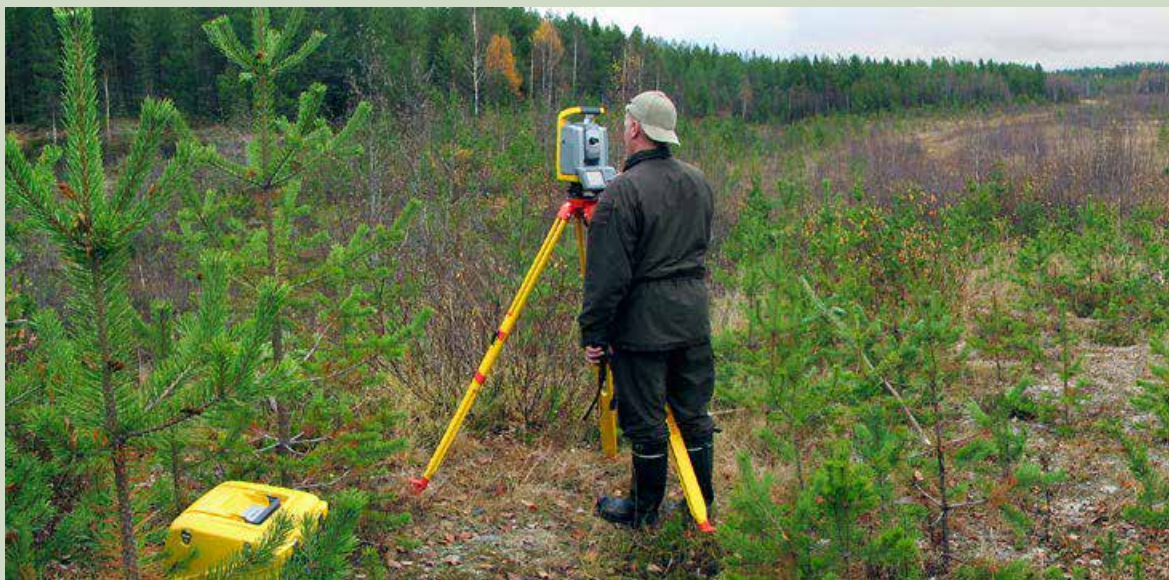
Kuva 3. Takymetrimittauksen tulokset ovat tarkat ja maanpinnan muotoja voi havainnollistaa saadun aineiston avulla monipuolisesti. Aineiston perusteella voi vertailla joustavasti esimerkiksi kosteikon toteuttamisen vaihtoehtoja. Kuva: Juha Siekkinen.
