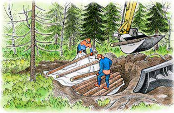
Kuva 36. Vinovaakapuupato voidaan tehdä henkilö- ja konetyön yhdistelmänä. Usein koneen kuljettaja pystyy tekemään padon yksinäänkin, kun puutavara on tehty valmiiksi. Ensin kaivetaan padolle paikka: siitä tehdään ojaa leveämpi ja syvämpi, jotta padosta saadaan tukeva ja pitävä. Kaivettavasta maasta ja ojamaista rakennetaan viisto patovalli, joka ulottuu sarkapintaa ylemmäksi. Valiin päälle laitetaan vaakasuorat tukipuut koko patovallin korkeudelle. Suodatinkangas voidaan laittaa oman maun mukaan puiden alle tai päälle. Kuvan tapauksessa vesi virtaa kaivinkoneen suunnasta. Tämä patomalli sopii lähes kaikkiin puustoisten soiden ennallistamiskohteisiin. Kuva: Tupu Vuorinen.
