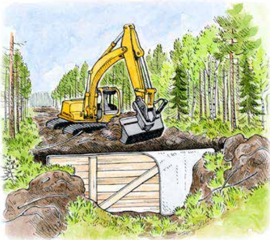
Kuva 34. Ponttilautapatoja voidaan käyttää isojen tai syöpyneiden ojen patoamisessa. Puurakenteiden päälle laitettava suodatinkangas on piirretty kuviin vain osittain, jotta padon rakenteet näkyvät. Kuvat: Tupu Vuorinen.
