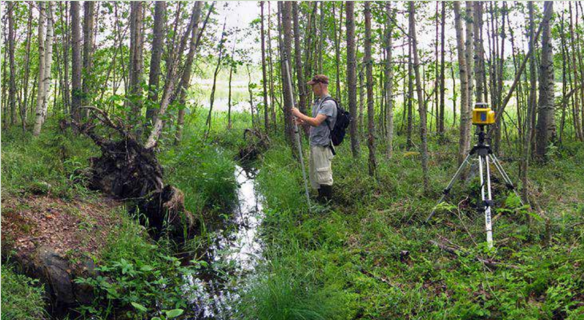
Kuva 1. Tasolasermittaus on helppo tehdä yksin ja menetelmä on tarkka. Kuva: Juha Siekkinen.
