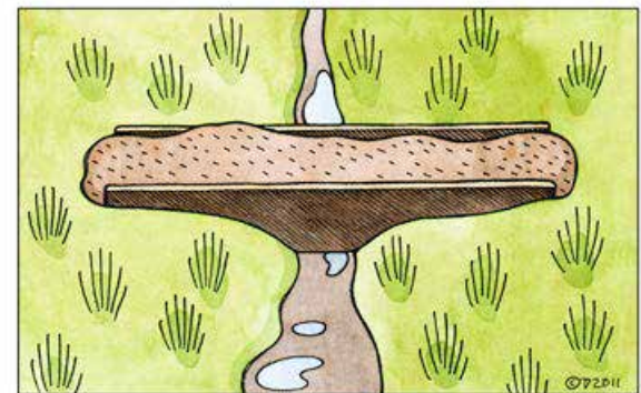
Kuva 38. Vesivaneripatoa voidaan käyttää mm. navero-ojan tukkimiseen. Vesivanerista sahataan ojan leveyttä ja syvyyttä suuremmat palat. Upotusta varten vanerille voidaan sahata suohon urat pitkälaippaisella moottorisahalla. Vanerit upotetaan turpeeseen esimerkiksi lekalla lyömällä. Lopuksi lapioidaan turvetta vanereiden väli täyteen niin tiiviisti, että kaikki mahdolliset veden mentävät raot saadaan tukittua turpeella. Kuvat: Tupu Vuorinen.
