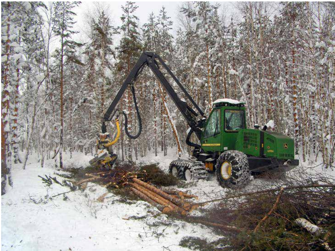
Kuva 24. Monitoimikone aloittelemassa alun perin avoimen suon puuston korjuuta. Moto on kasannut myös hakkuutähteet, koska ne kerättiin tällä kohteella pois suolta. Haukkaneva, Virrat 2010. Kuva: Pekka Vesterinen.
