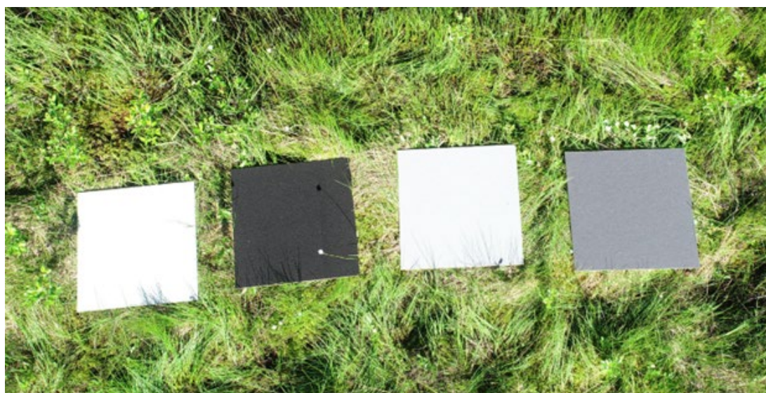
Kuva 16. Radiometrinen kalibrointilevysarja. Hankkeessa multispektrikuvausten kalibrointiin käytettiin pääasiassa MosaicMillin neljää 50 cm × 50 cm levyä (heijastavuudet 2 %, 9 %, 23 % ja 46 %). Levyjen heijastavuus tulisi olla samaa luokkaa kuin kartoitettavalla kohteella. Kalibrointiin riittää yleensä yksi levy, mutta useammalla levyllä kalibroinnin voi todentaa. Kuvattaessa levyjen valaistuksen tulisi vastata kohteen valaistusta. Tässä kuvassa kasvillisuus ja sen aiheuttamat varjot ovat osittain levyjen päällä, mutta suurinta osaa levyjen pinta-alasta voidaan tässäkin käyttää kalibrointiin. Kuva: Maarit Similä.
