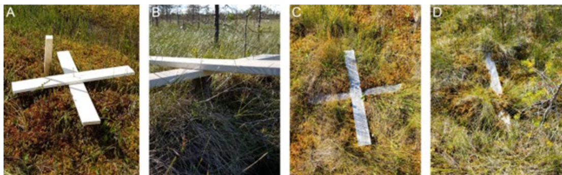
Kuva 15. Kiinteitä maatukipisteitä ennen ennallistamista ja sen jälkeen (kaikissa kuvissa eri tukipisteet). Teroitettu paalu (A) lyödään turpeen läpi tukevasti kiinni mineraalimaan ja sen päähän kiinnitetään lautaristi tai muu ilmakuvista helposti havaittava kohde. Kiinnitysruuveja on syytä olla kaksi pyörimisen estämiseksi. Puiden kantoihin kiinnitetyt tukipisteet (B) puolestaan ankkuroituvat suon pintakerrokseen ja ovat siksi liikkumisherkkiä suon pinnan eläessä. Olvassuon Ison Leväniemen kohteella suon turpoaminen ja rahkasammalten kasvu peittivät tukipisteitä osittain jo neljässä vuodessa niiden rakentamisen ja ennallistamisen jälkeen (C–D). Tästä syystä kiinteät tukipisteet kannattaa alun perin rakentaa jonkin verran suon pintaa korkeammalle. Kuvat: Lauri Ikkala.
