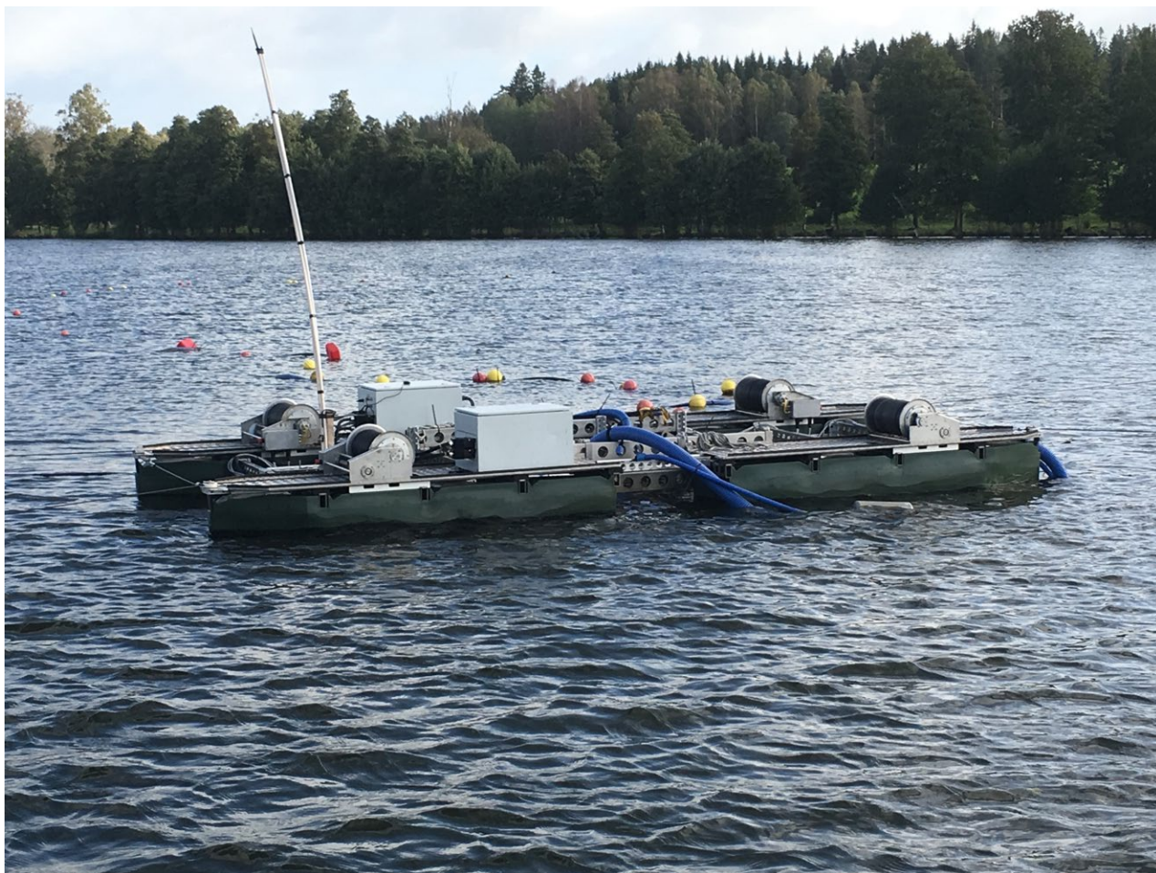
Kuva 50. Sedimentin poisto käynnissä Jönköpingissä Ruotsissa (Barnarpasjön) 2018 alhaisen virtauksen imuruoppauslaitteistolla. Kuva: Irma Puttonen / Åbo Akademi.
