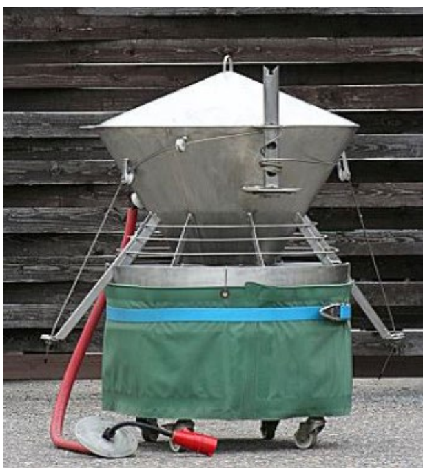
Kuva 30. Mixox MC 1100 hapetin (halkaisija 110 cm). Kuva: Saarijärvi ym. (20129).
