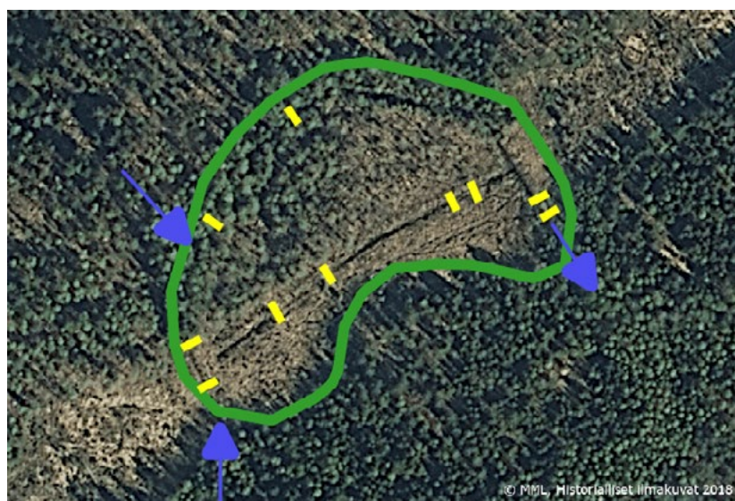
Kuva 83. Huppionvuoren letto (vihreä raja) vuoden 2018 ilmakuvalla. Vesien pääasialliset tulevat purkukohtat ja lähtevä uoma on merkitty sinisin nuolin. Vuonna 1999 tehtyjen kaivuripatojen paikat on merkitty keltaisella. © Maanmittauslaitos 2025.
