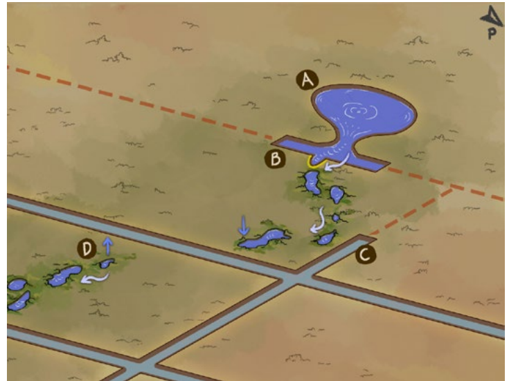
Kuva 121. Keskeneräinen työmaa. A) Allikon välittömässä läheisyydessä ei liikuttu koneella. B) Läntisin oja on täytetty ja siihen on jätetty lähteen kohdalle täyttökotko. Kuvaan on merkitty keltaisella vedenohjausura. C) Ojien täytössä on edetty niille paikkeille, missä oja kulkee lähimpänä piilopuroa. D) Lämpökamera paljastaa, että lähdevesi on löytänyt reitin ojan alla säilynyttä piilopuroa pitkin seuraavalle saralle. Täytetyt ojat on merkitty kuvaan punaisella katkoviivalla. Kuva: lina Eskelinen.
