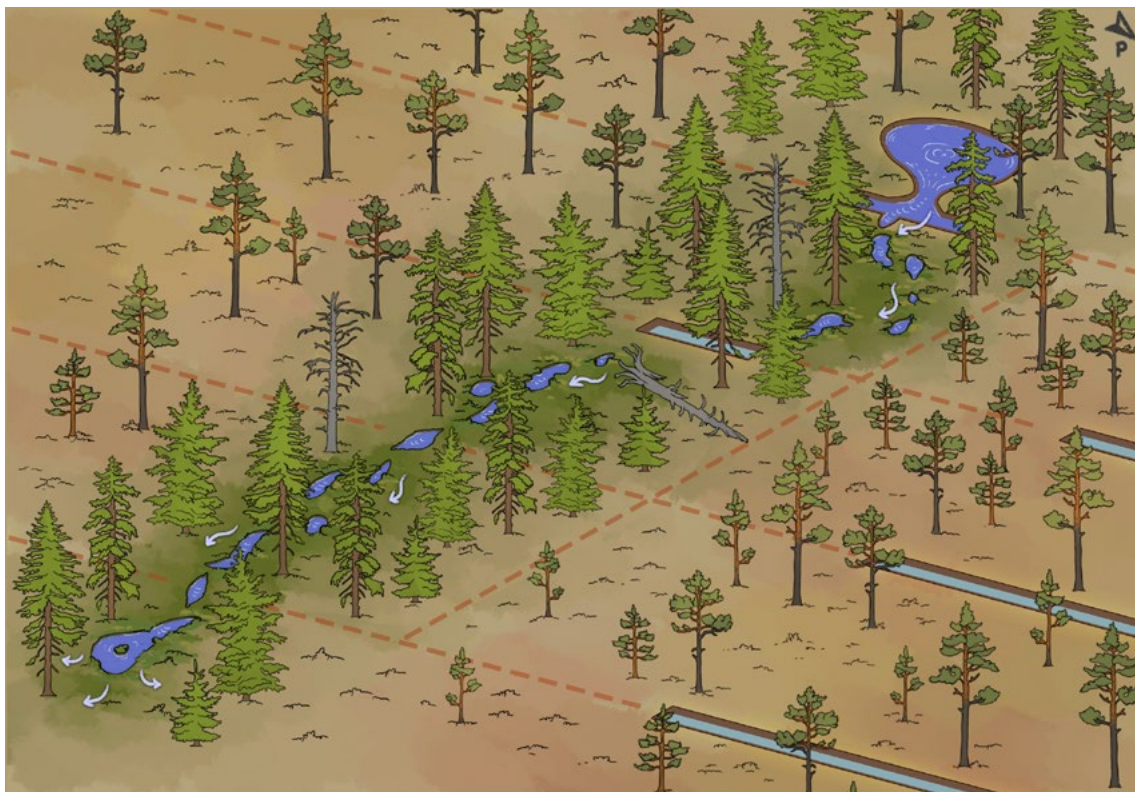
Kuva 124. Valmis ennallistamistyömaa. Täytetyt ojat on merkitty kuvaan katkoviivalla. Kuva: lina Eskelinen.
