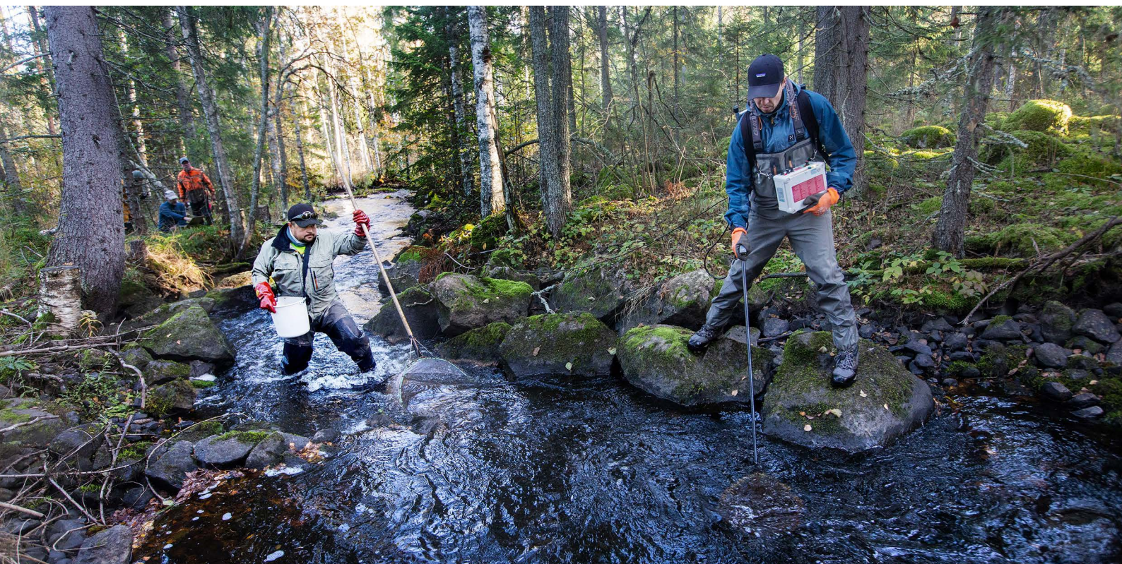
Miika Sarpakunnas (blå jacka) och Jani Palenius utför elprovfiske längs med Saarinen i Myllyjoki. För elprovfiske krävs tillstånd av vattenområdets ägare och NTM-centralen samt lämplig utbildning. Elprovfiskeanordningen bildar ett elektriskt fält i vattnet som bedövar fiskarna och styr dem till fångstredskapet. Spänningen är 600 volt.
