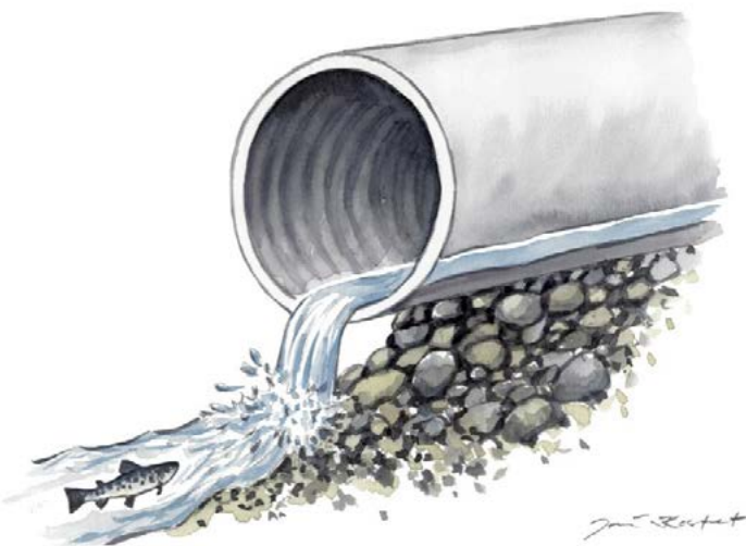
Kuva 75. Rummun alapään pudotus ja veden vähyyys aiheuttavat kokoaikaisen vaellusesteen. KUVA: JARI KOSTET.
