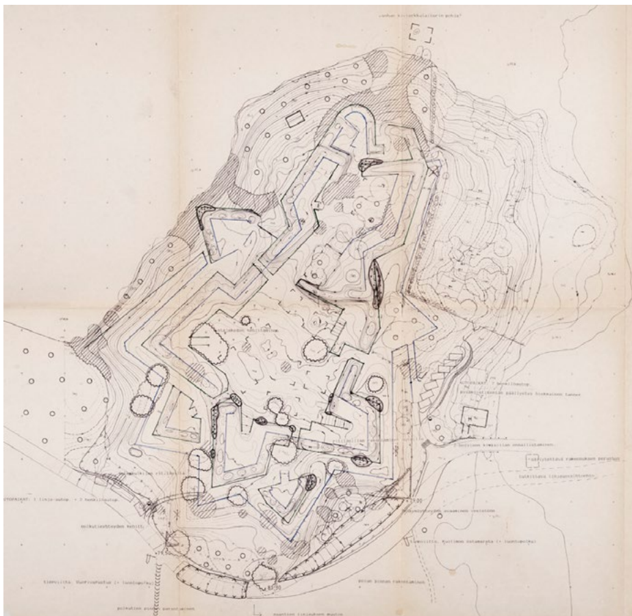
Osakopio Ympäristösuunnittelu Henttosen maisemasuunnitelmasta 11.1.1988. Suunnitelmassa on mm. maantien linjauksen ja vallien ennallistaminen, suunnitelmia poluista ja autopai-koista. Ensivaiheessa korjattavat, sortuneet muurit on merkattu paksuilla pisterasteroineilla. Suojeltavat yksittäispuut on merkitty paksummalla tus-sauksella. Kaakkoisen puolibas-tionin kärjestä on esitetty avat-tavaksi näkymä Kärnäkoskeen. Hd:15:1, MV.
